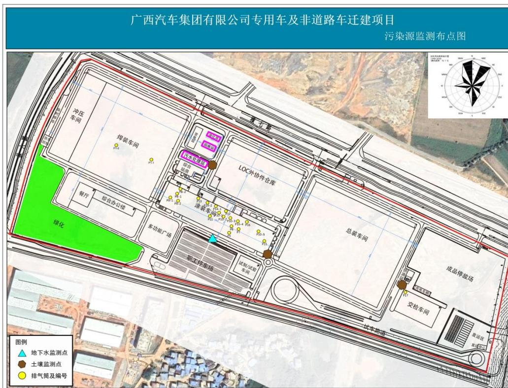
图8.5-1 项目地下水污染源监测布点图
